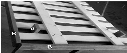
Tisch bereitstellen und mit Decke versehen. Ausrichte der senkrechten Latten und der waagerechten Querriegel (Tipp: mit Abstandklötzen (oder Zaunlatte) 74mm (A) und Anschlagleisten im rechten Winkel (B) 4 x 35mm Schrauben in die vorgebohrten Löcher der Querriegel stecken und verschrauben.
