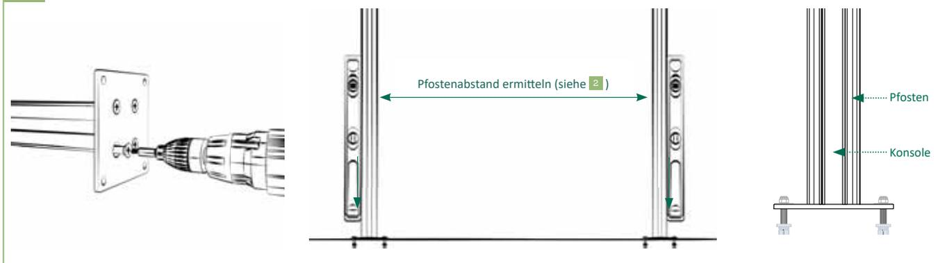
2a | Konsolen auf die Pfosten stecken und mit den mitgelieferten Schrauben von unten fest verschrauben. Ausrichtung der Konsolen bei aufgesteckten Pfosten, danach auf den Untergrund aufdübeln.
