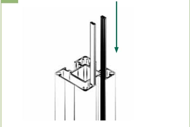
5 | Jeweils zwei der mitgelieferten Bürstendichtungen in die Pfostennuten einschieben.
