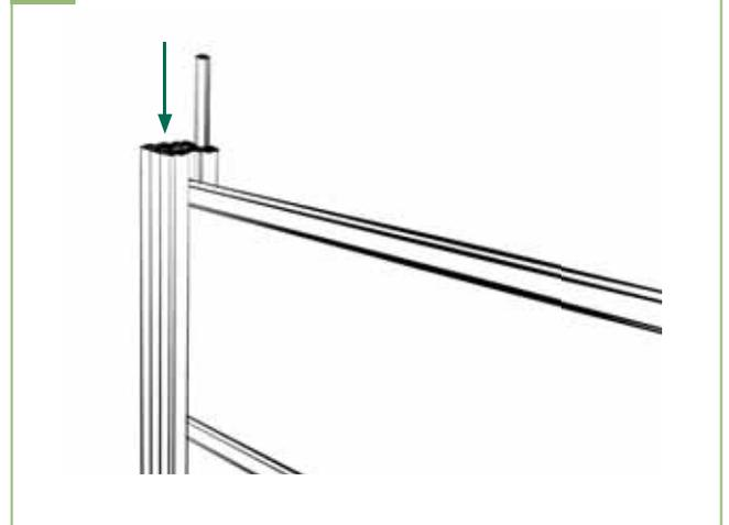
8 | Die Pfostenabdeckleisten von oben in die Pfostennut einschieben und mit der Unterkante des Pfostens bündig abschließen.
