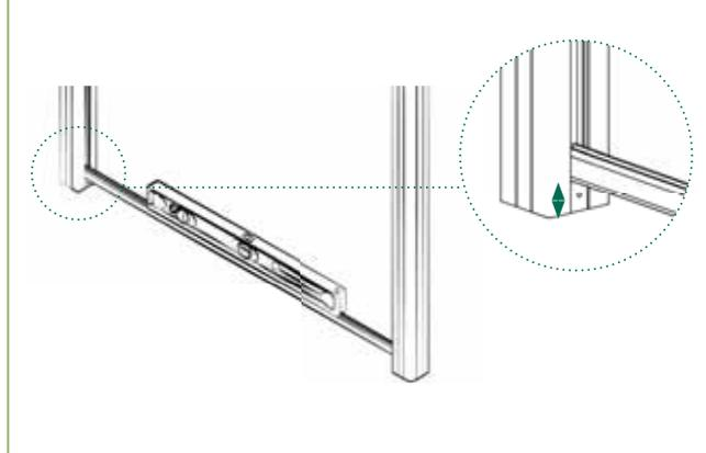
4 | Zuerst auf einer Seite das Distanzstück befestigen. Das Distanzstück der zweiten Seite mit Hilfe der U-Leiste und einer Wasserwaage ausrichten und befestigen.
