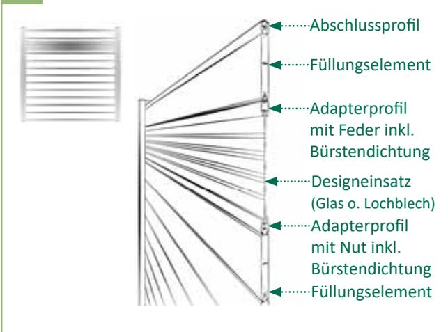
7a | Die Füllungselemente nacheinander von oben einschieben, dabei die Feder der Füllungselemente nach oben ausrichten. Bei der Montage des Designeinsatzes folgende Reihenfolge beachten: Adapterprofil mit Nut, Designelement, Adapterprofil mit Feder. Danach ein Füllungselement einschieben und das Abschlussprofil aufsetzen.
