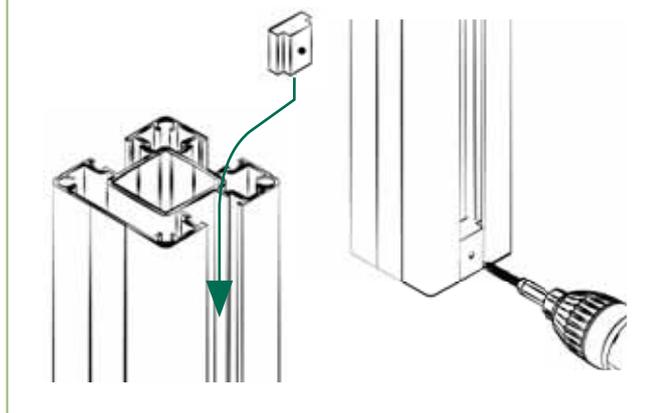
3 | Distanzstück hochkant in die Innenseite der Pfostennut einschieben, bündig mit der Unterkante des Pfostens abschließen, vorbohren und verschrauben.
