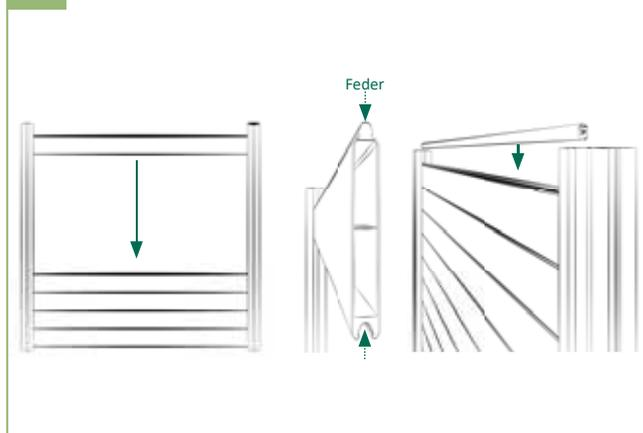
6 | Die Füllungselemente nacheinander von oben einschieben, dabei die Feder der Füllungselemente nach oben ausrichten. Mit dem Abschlussprofil abschließen.
