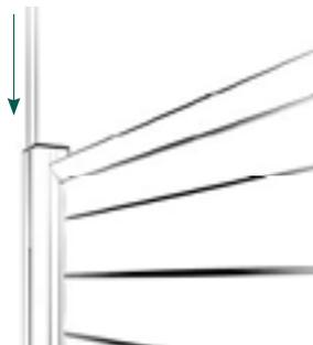
7 | Die Pfostenabdeckleisten von oben in die Pfostennut einschieben und mit der Unterkante des Pfostens bündig abschließen.
