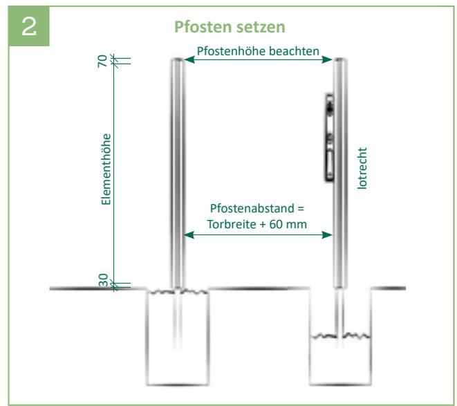
1 | Größe der Fundamente mindestens 500 x 500 x 800 mm sowie unter Berücksichtigung der Bodenbeschaffenheit.\* Ungefähr die Hälfte des Erdloches mit Beton füllen und verdichten. Anschließend die Pfosten setzen und ausrichten. Das Erdloch komplett mit Beton füllen und verdichten.
