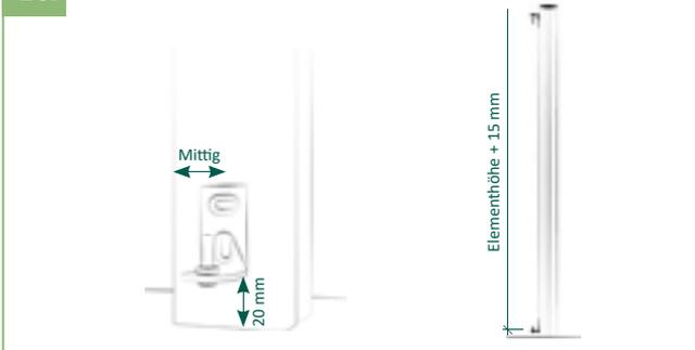
4a | Unteres Scharnier 20 mm vom Boden mittig auf den Pfosten setzen. Pro Loch mit 3 mm, danach mit 7 mm vorbohren und anschließend mit einem M8 Gewindeschneider nachsetzen, Schrauben eindrehen. Der Abstand zwischen Oberkante des oberen Scharniers und Unterkante des unteren Scharniers beträgt 1815 mm.
