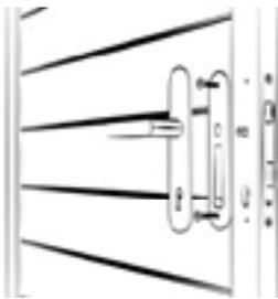
5c | Gegenüberliegend die Drückerbefestigung verschrauben und die Drückerblende aufstecken.
