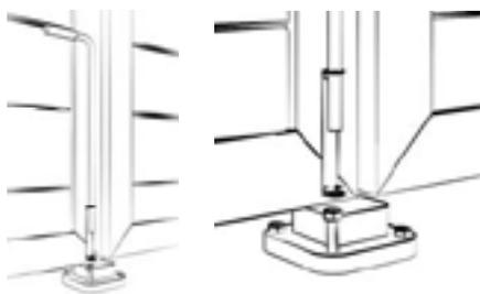
6 | Die Auflaufstütze mit vier Sechskantschrauben auf einen festen Untergrund (Betonsockel) verschrauben. Den Bodenriegel passend zur Auflaufstütze montieren.
