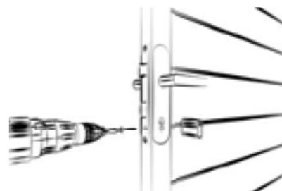
5d | Schließzylinder einsetzen und verschrauben
