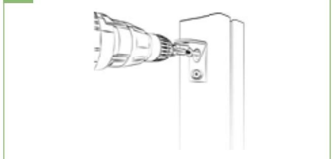
4b | Oberes Scharnier mit dem vorgegebenen Abstand vom unteren Scharnier befestigen. Pro Loch mit 3 mm, danach mit 7 mm vorbohren und anschließend mit einem M8 Gewindeschneider nachsetzen, Schrauben eindrehen.
