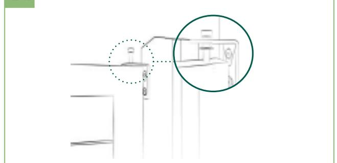
4d | Das Tor aufrichten und die Sechskantschraube mit der Kunststoffunterlegscheibe (zwischen Scharnier und Torrahmen) einschrauben. Die Schraube so eindrehen, dass der Kopf der Schraube im Winkel verschwindet.
