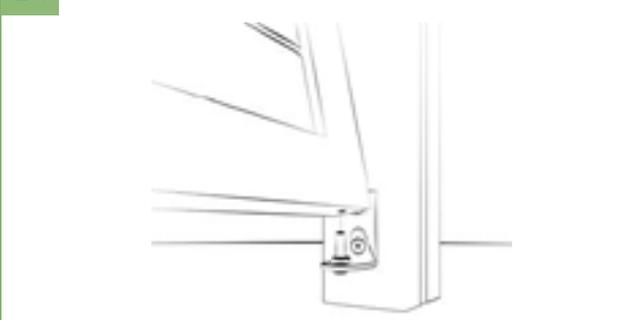
4c | In die Unterseite des Tores die Sechskantschraube mit Gleitlager und Metallunterlegscheibe einschrauben und in das untere Scharnier einsetzen.
