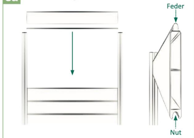
5a) Es können zusätzlich Lisenen zwischen die Füllungselemente nacheinander von oben eingeschoben werden. Hierbei ebenfalls die Nut- und Federausrichtung berücksichtigen.
