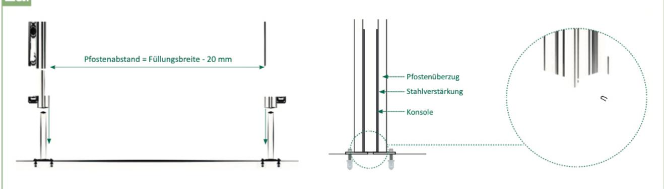
2a) Ausrichtung der Konsolen bei aufgesteckten Pfosten, danach aufdübeln. Der Pfostenüberzug und die Stahlverstärkung schließen nach dem Aufsetzen des Pfostens bündig ab.\*
