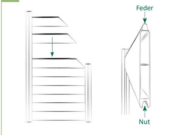
5 | Die Füllungs-elemente nacheinander von oben einschieben, dabei die Feder der Füllungs-elemente nach oben ausrichten.
