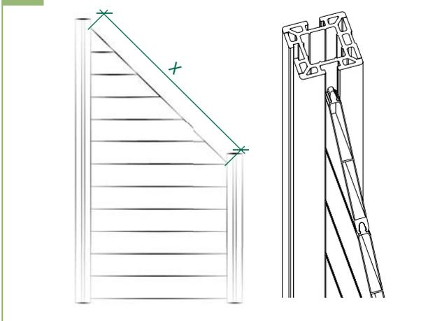
6a | Messen Sie die oben angegebene Länge. Bitte messen Sie immer von der Innenkante bis zur Innenkante des Pfostens!
