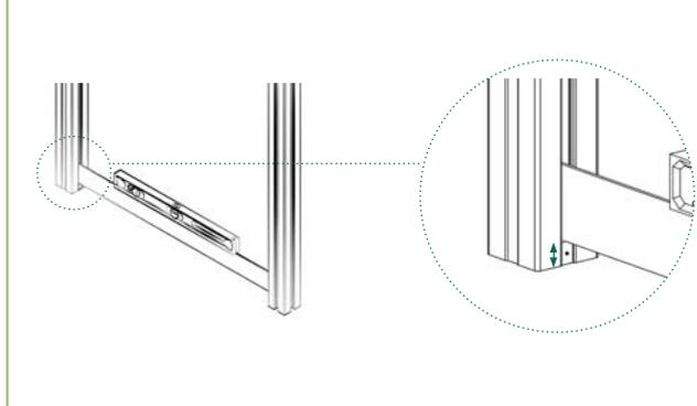
4 | Zuerst auf einer Seite das Distanzstück befestigen. Das Distanzstück der zweiten Seite mit Hilfe eines Füllungs-elementes und einer Wasserwaage ausrichten und befestigen.
