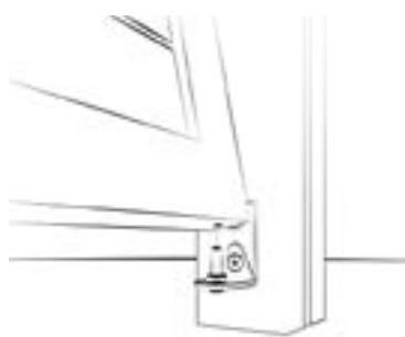
4c | In die Unterseite des Tores die Sechskantschraube mit Gleitlager und Metallunterlegscheibe einschrauben und in das untere Scharnier einsetzen.
