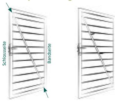
3a | Mit einem 4,5 mm Bohrer durch die erste Wandung der WPC- Füllung bohren, dann die Kunststoffdübel vorsichtig bündig einschlagen. Die Diagonalstrebe wieder einsetzen und mit den mitgelieferten Schrauben von Hand befestigen.
