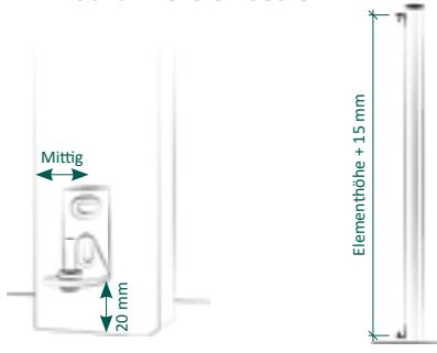
4a | Unteres Scharnier 20 mm vom Boden mittig auf den Pfosten setzen. Pro Loch mit 3 mm, danach mit 7 mm vorbohren und anschließend mit einem M8 Gewindeschneider nachsetzen, Schrauben eindrehen. Der Abstand zwischen Oberkante des oberen Scharnieres und Unterkante des unteren Scharnieres beträgt 1815 mm.
