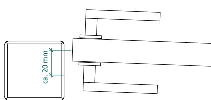
6a | Das Tor ca. 20 mm öffnen, damit sich der Anschlag noch montieren lässt. Den Anschlag zwischen Pfosten und Torelement halten, um den richtigen Abstand zu bestimmen.
