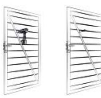
3b | Diagonalstrebe auf der gewünschten Seite des Tores positionieren. Von unten Bandseite, nach oben Schlossseite! Alle drei Löcher anzeichnen und Diagonalstrebe wieder herausnehmen.
