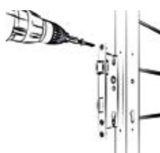
5a | Einstekschloss einsetzen, oben und unten verschrauben.
