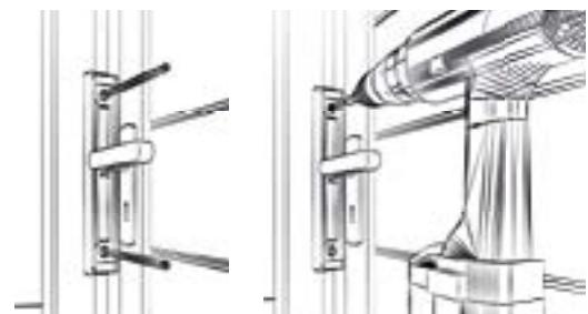
6b | Um die Position des Anschlages festzulegen, müssen Markierungen auf den Pfosten angezeichnet werden. Die Löcher zuerst mit einem 3 mm, danach mit einem 7 mm Bohrer vorbohren und dann mit einem M8 Gewindeschneider nachsetzen. Schrauben eindrehen.
