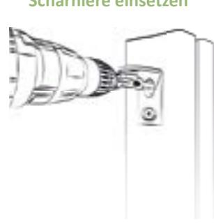
4b | Oberes Scharnier mit dem vorgegebenen Abstand vom unteren Scharnier befestigen. Pro Loch mit 3 mm, danach mit 7 mm vorbohren und anschließend mit einem M8 Gewindeschneider nachsetzen, Schrauben eindrehen.
