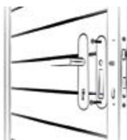
5c | Einstekschloss einsetzen, oben und unten verschrauben.
