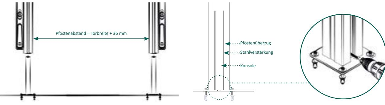
2a | Ausrichtung der Konsolen bei aufgesteckten Pfosten, danach aufdübeln. Der Pfostenüberzug und die Stahlverstärkung schließen nach dem Aufsetzen des Pfostens bündig ab.\*
