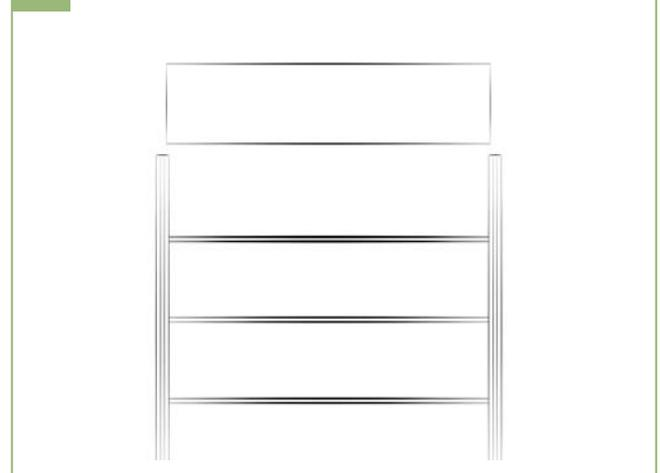
4 | Nach der Befestigung aller Elementhalter wird das Zaunelement mit jeweils zwei selbst schneidenden Schrauben  $\varnothing$  3,9 x 19 mm pro Elementhalter rückseitig befestigt. Bitte vorbohren!
