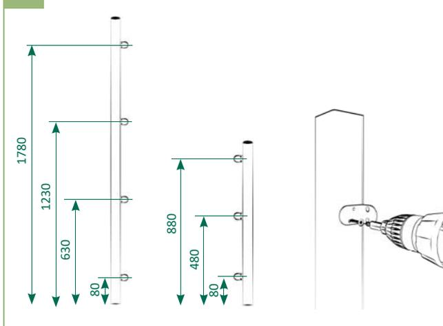
3 | Die Elementhalter mit zwei selbst schneidenden Schrauben  $\varnothing$  3,9 x 25 mm am Pfosten befestigen. Es wird empfohlen, die Schraubenlöcher mit einem 3,3 mm Bohrer vorzubohren! Die Halter entsprechend der Maßangaben montiere.
