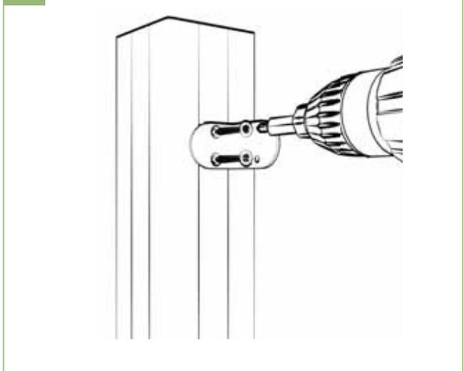
3b | Die Befestigungswinkel mit den mitgelieferten Schrauben am Pfosten befestigen. Die Schraublöcher mit einem 3 mm Bohrer vorbohren!
