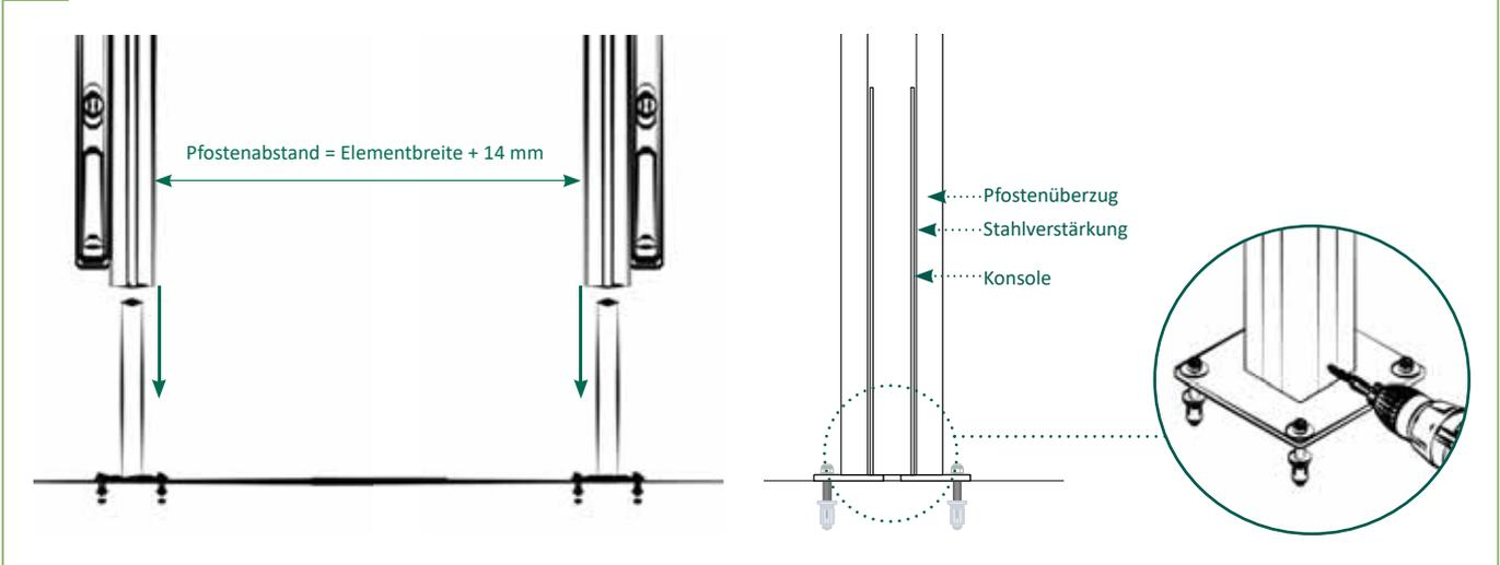
2a | Ausrichtung der Konsolen bei aufgesteckten Pfosten, danach aufdübeln. Der Pfostenüberzug und die Stahlverstärkung schließen nach dem Aufsetzen des Pfostens bündig ab.\*
