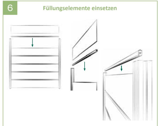
6 | Das U-Profil in die Pfosten von oben einschieben. Danach vorsichtig die Füllungselemente und die H-Profile im Wechsel einsetzen. Mit dem Abschlussprofil abschließen.
