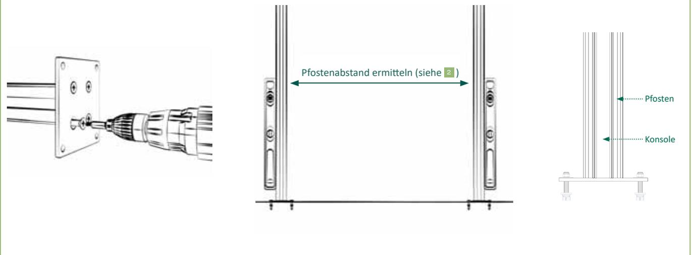
2a | Konsolen auf die Pfosten stecken und mit den mitgelieferten Schrauben von unten fest verschrauben. Ausrichtung der Konsolen bei aufgesteckten Pfosten, danach auf den Untergrund aufdübeln. Die Pfosten schließen nach dem Aufsetzen bündig mit den Konsolen ab.
