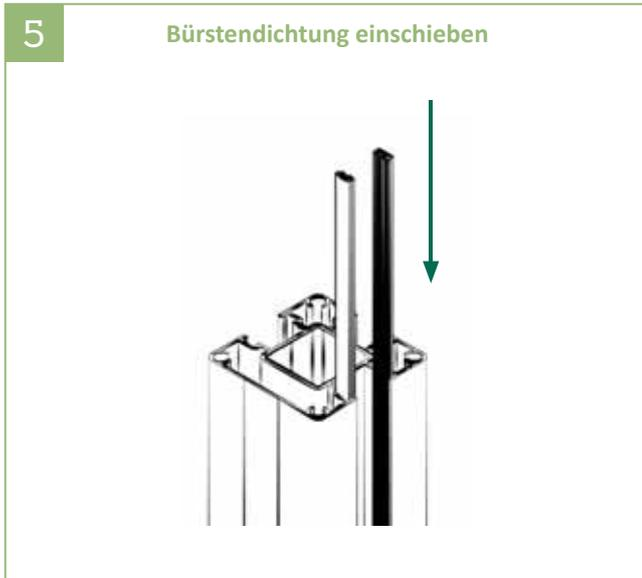
5 | Jeweils zwei der mitgelieferten Bürstendichtungen in die Pfostennuten einschieben.
