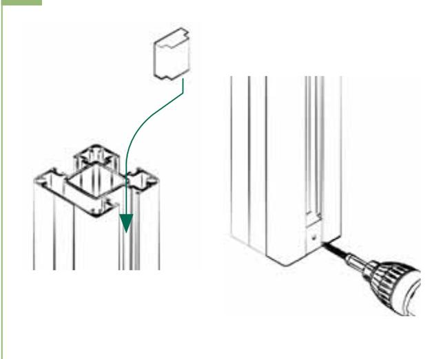
3 | Distanzstück hochkant in die Innenseite der Pfostenut einschieben, bündig mit der Unterkante des Pfostens abschließen, vorbohren und verschrauben.
