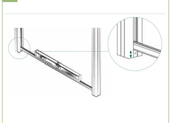
4 | Zuerst auf einer Seite das Distanzstück befestigen. Das Distanzstück der zweiten Seite mit Hilfe der U-Leiste und einer Wasserwaage ausrichten und befestigen.
