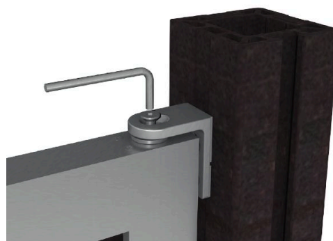
Oberer Lagerzapfen festschrauben
