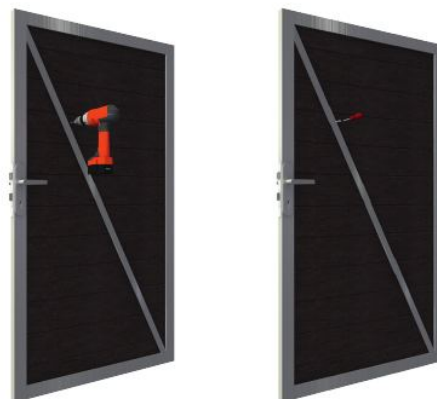
Bohren, Dübel einschlagen, Strebe festschrauben
