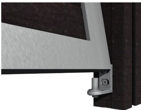
Tor auf das untere Torlager setzen
