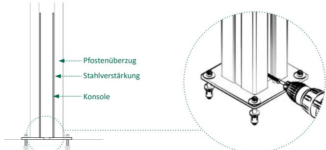
2a | Ausrichtung der Konsolen bei aufgesteckten Pfosten, danach aufdübeln. Der Pfostenüberzug und die Stahlverstärkung schließen nach dem Aufsetzen des Pfostens bündig ab.\*
