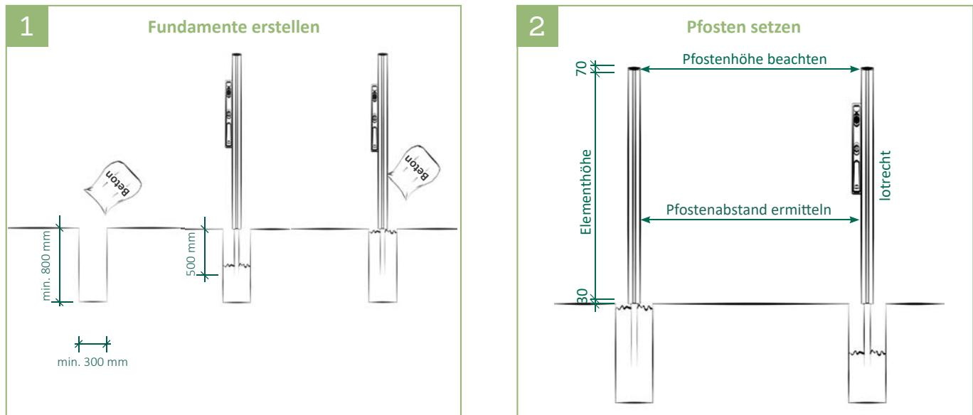
1| Größe der Fundamente mindestens 300 x 300 x 800 mm sowie unter Berücksichtigung der Bodenbeschaffenheit.\* Ungefähr die Hälfte des Erdloches mit Beton füllen und verdichten. Anschließend die Pfosten setzen und ausrichten. Das Erdloch komplett mit Beton füllen und verdichten.
