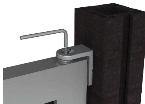
Oberen Lagerzapfen mit der Senkschraube befestigen
