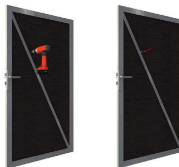
Mit 4,5 mm vorbohren, Dübel einschlagen, Strebe anschrauben
