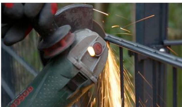
Damit die letzte Doppelstabmatte genau mit Ihrem Grundstück abschließt, muss diese mit hoher Wahrscheinlichkeit gekürzt werden. Hierfür verwenden Sie am Besten einen Handtrennschleifer, mit dem Sie die Doppelstabmatte durchtrennen
