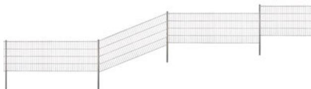
Der Kürzung der Matten entsprechend verkürzen sich natürlich auch die Abstände der Pfosten, daher ist es wichtig den zweiten Pfosten erst nach dem Kürzen der Doppelstabmatte zu setzen. Die nun folgenden Zaunelemente und Pfosten können Sie wie schon in den vorherigen Schritten ausrichten und befestigen.
