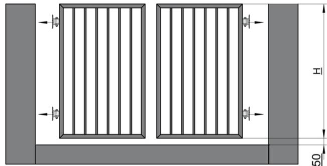
Jeder Scharniersockel benötigt 4 Befestigungslöcher, die in den vorhandenen Pfosten gebohrt werden müssen, und ein 40-50 mm tiefes Loch für M16 oder M20, je nach bestelltem Scharnier.
