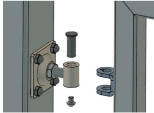
Setzen Sie die Pfosten mit der montierten Gehür in den Beton, so dass die Pfosten auf gleicher Höhe liegen. Schrauben Sie das Schloss und den Anschlag so ein, dass der Anschlag die falsche Richtung der Öffnung des Flügels verhindert. Sichern Sie die Konstruktion mit einer Schalung wie in der nebenstehenden Abbildung gezeigt und lassen Sie sie 3 Wochen lang so stehen.
