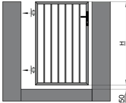
Jeder Scharniersockel benötigt 4 Befestigungslöcher, die in den vorhandenen Pfosten gebohrt werden müssen, und ein 40-50 mm tiefes Loch für M16 oder M20, je nach bestelltem Scharnier.
