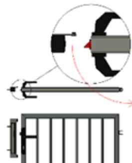
Montieren Sie das Schloss und markieren Sie dann die gemessene Höhe des Schlosses am Pfosten. Überprüfen Sie die Position der beiden Teile zueinander, indem Sie den Anschlag am Schloss anbringen. Montieren Sie den Anschlag.
