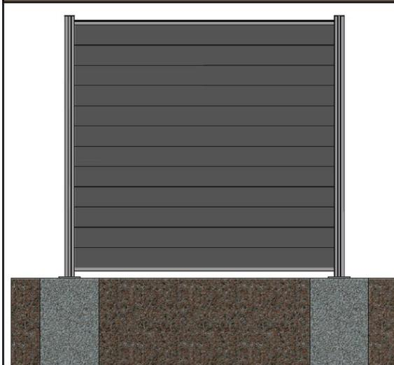
Fertiges Element, Pfosten einbetoniert
