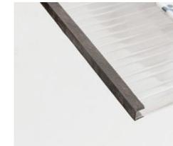
18. Über das Anti-Dust-Tape wird das Alu-Abschlussprofil mit den Ablaufbohrungen geschoben und auf der Oberseite mit Silikon abgedichtet. Weiße Abschlussprofile sind bauseits zu bohren.
