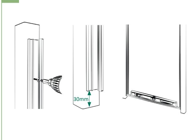
3 | Die Klemmschiene wird mittig mit einem unteren Abstand von 30 mm auf den Pfosten befestigt. Die Schraublöcher bitte mit einem 3 mm Bohrer vorbohren! Die zweite Klemmschiene am gegenüber stehenden Pfosten mit Hilfe einer Holzleiste und einer Wasserwaage befestigen.
