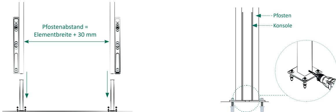
2a | Ausrichtung der Konsolen bei aufgesteckten Pfosten, danach aufdübeln\*.
