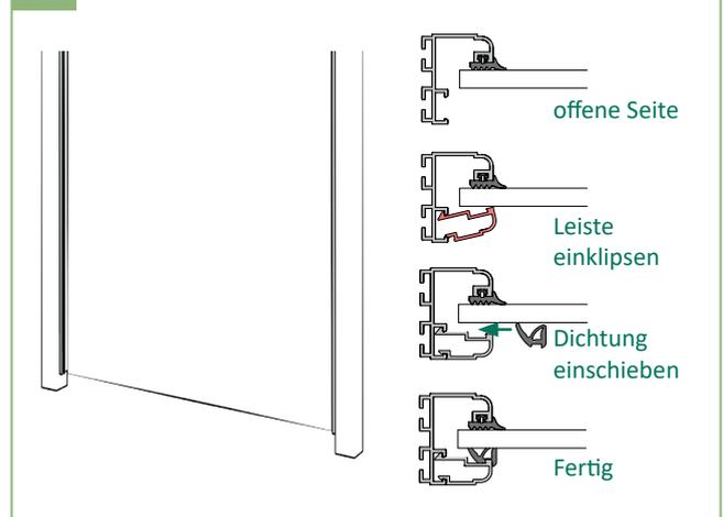
4 | Die Füllung mittig zwischen den Klemmschienen auf den Aluminium-Auflagewinkeln vorsichtig positionieren. Die Leiste mit der Rastnase in die Klemmschiene einklippen und nach vorne schwenken, bis die vordere Rastnase einrastet. Danach die Dichtung wie dargestellt einschieben.
